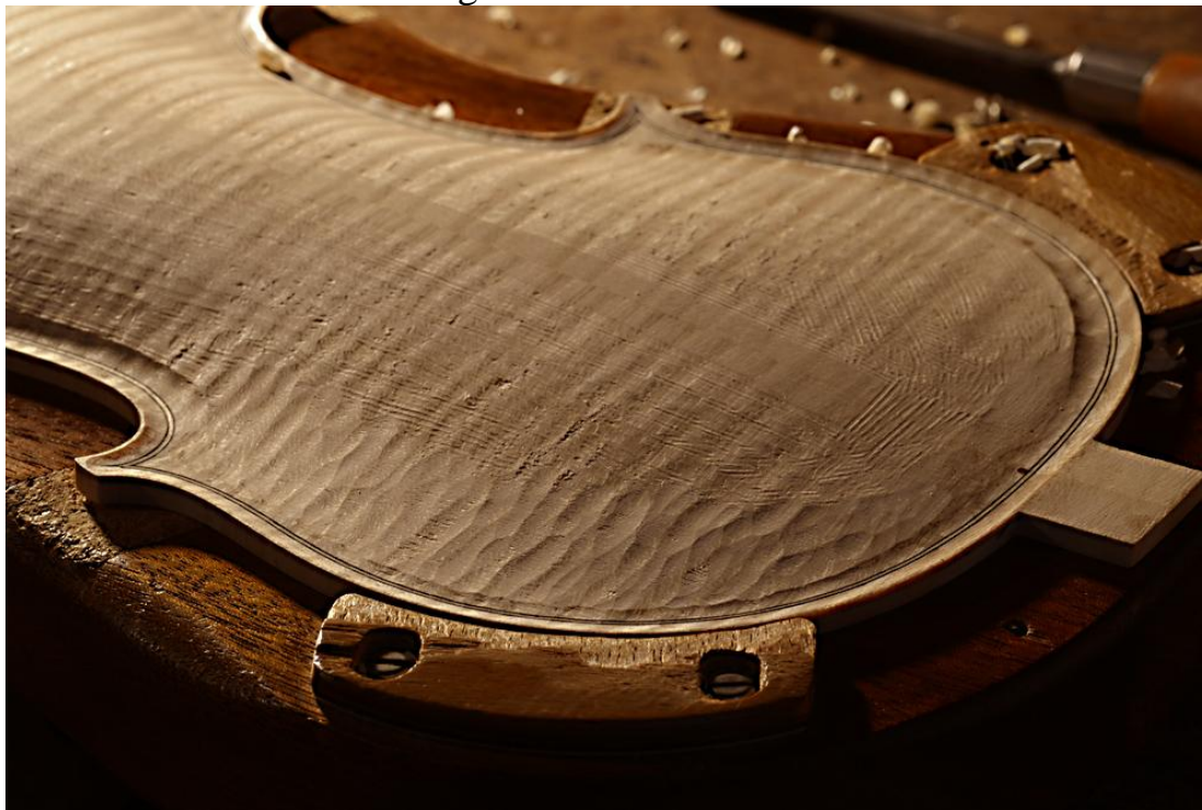
Raccordo del canale della sguscia sul fondo
