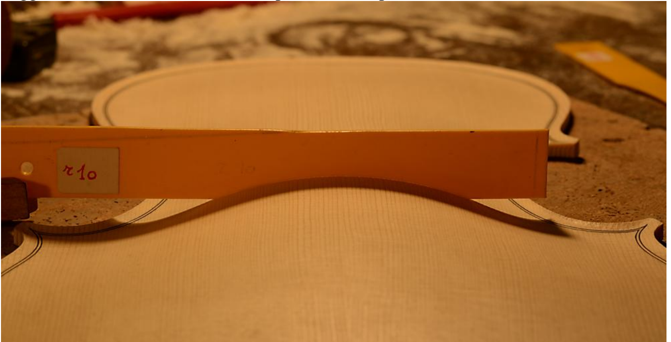
Raggio di curvatura della tavola alla posizione del ponticello
