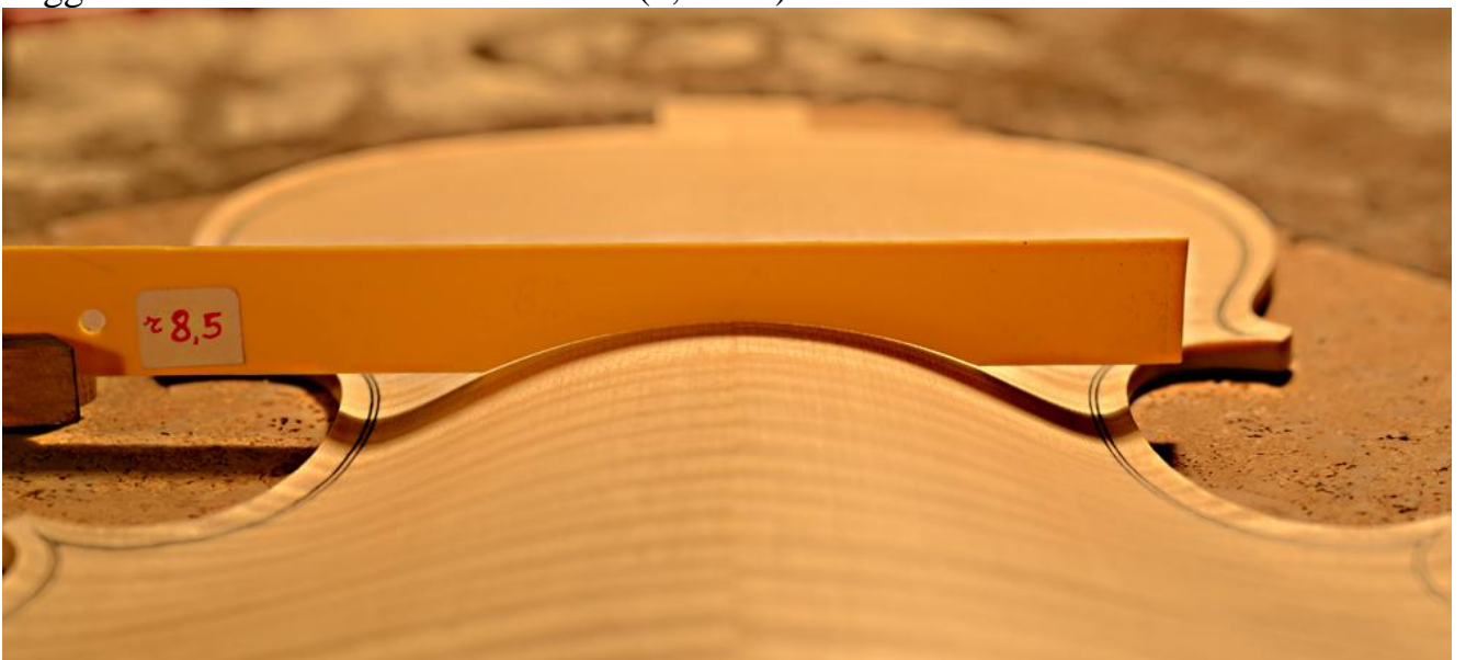
Raggio di curvatura minimo del fondo (8,2 mm)
