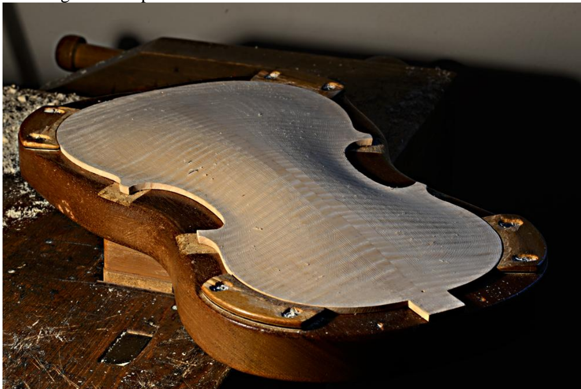
Fondo sgrossato a pialletto dentato
