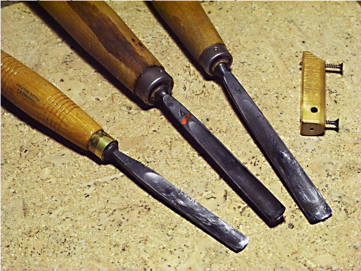
Sgorbie per la sguscia e graffietto per tracciare le larghezze del canale
