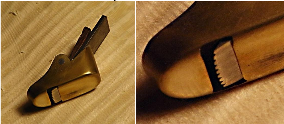
Pialletto con lama dentata per il fondo
