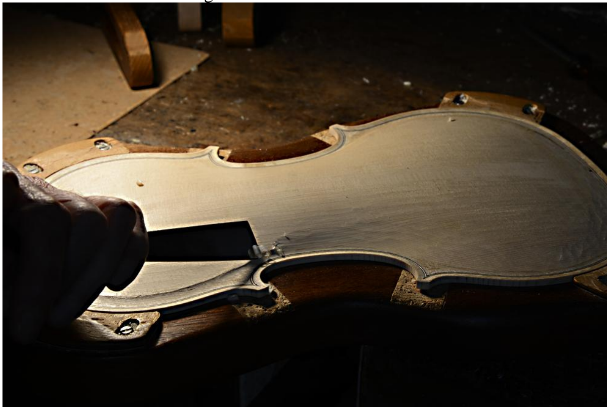
Raccordo del canale della sguscia sulla tavola
